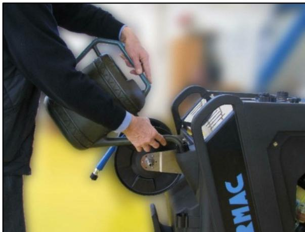
Le bouchon de remplissage du gasoil est facilement accessible. Un support spécifique permet un rangement simplifié du câble d'alimentation. Il est également possible de mettre en place un support pour le flexible haute pression sur les versions sans enrouleur.
