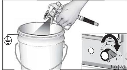
Contrôlez l'étanchéité des raccords. Ne stoppez pas une fuite avec la main ou un chiffon. En cas de fuite, arrêtez le pulvérisateur immédiatement. Exécutez la **procédure de décompression**, étapes 1 à 3, page 8. Resserrez les raccords non étanches.
