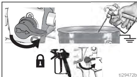
12. Tournez le bouton de commande de pression sur la pression minimale et mettez l'interrupteur MARCHE/ARRÊT sur la position **ARRÊT**. Débranchez l'alimentation électrique du pulvérisateur.
