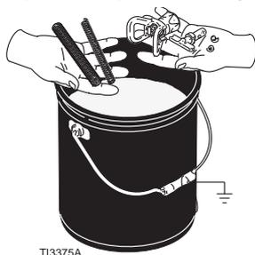
3. Sortir le tuyau de succion de la peinture et le plonger dans le produit de rinçage. Utilisez de l'eau ou du fluidifiant pour pompe pour une peinture à base aqueuse et du white-spirit pour une peinture à l'huile.
